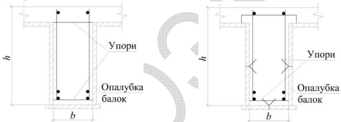
Рис. 19. Установка каркасів у опалубці
